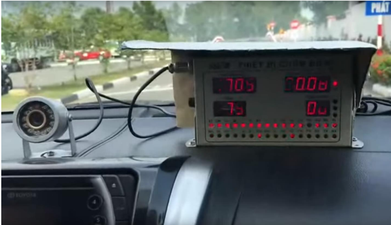
Hình 5.5 Thiết bị cảm ứng trên phương tiện
